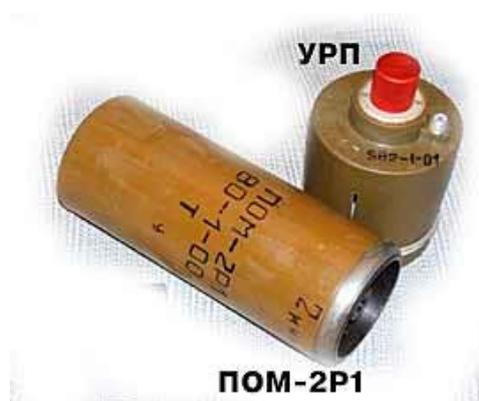
Мина ПОМ-2Р противопехотная осколочная кругового поражения. Предназначена для выведения из строя личного состава противника. Поражение человеку или нескольким наносится за счет поражения осколками корпуса при взрыве заряда мины в момент, когда человек заденет один из четырех датчиков цели (тонкие обрывные провода длиной по 10 м. каждый).
