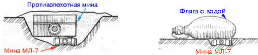
При использовании в качестве мины-ловушки МЛ-7 устанавливается на местности так, чтобы ее не было видно (например, в отрытую лунку), а на нее укладывается предмет, который обязательно вызовет интерес противника и побудит его поднять или воспользоваться им (оружие, предметы быта и т.п.). В этом случае поражение личному составу наносится за счет силы взрыва (фугасное воздействие).
