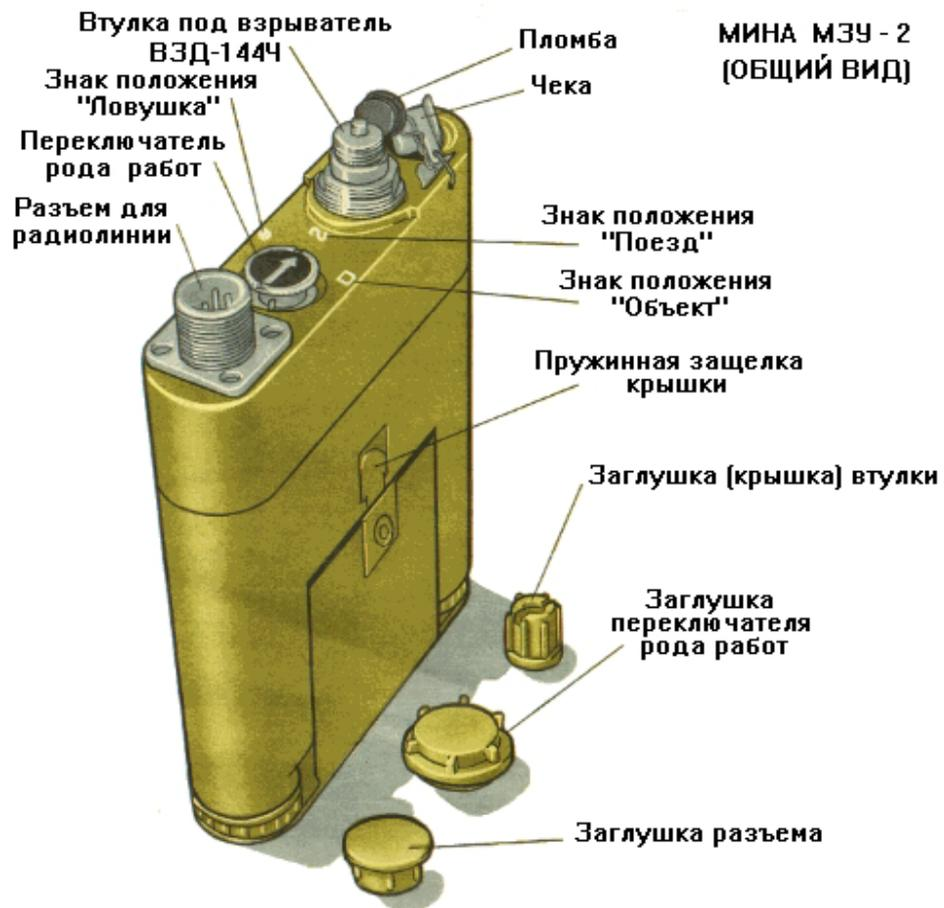
**Взрыватель МЗУ-2** окончательно снаряженный состоит из корпуса с крышкой, механизма дальнего взведения, резьбовой втулки с подпружиненной кнопкой, вилки разъема, трех датчиков цели (одного вибрационного и двух наклонных), электрической схемы, главным элементом которой является электронное реле, переключателя рода работ, обрывной петли, накольного механизма, запала МД-5М и детонатора.
