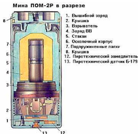
В минах ПОМ-2РБС, ПОМ-2Р1БС, УИ-ПОМ-2Р вместо механизмов самоликвидации установлены их весогабаритные макеты
