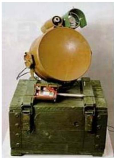
Предназначена для выведения из строя гусеничной и колесной техники противника. Поражение машинам противника наносится за счет пробивания бортовой брони ударным ядром, образующимся из обкладки кумулятивной воронки при взрыве мины. При проникновении ударного ядра внутрь танка происходит поражение членов экипажа и оборудования танка каплями расплавленной брони, высоким давлением, возникающим внутри и высокой температурой ядра. Это вызывает пожар внутри танка, возможна детонация боекомплекта
