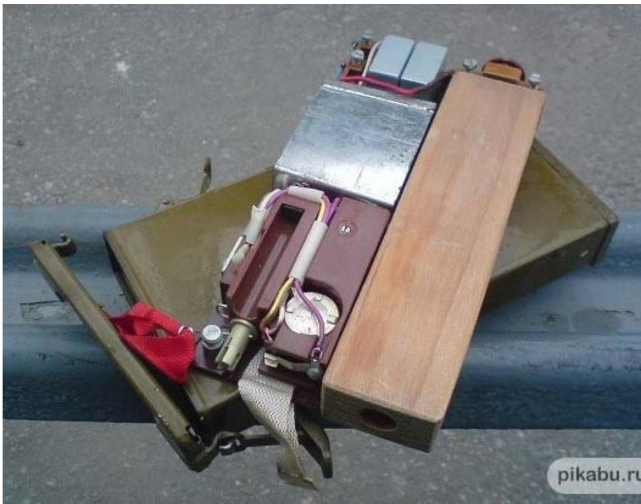
Футляр *1* — металлический, прямоугольной формы, имеет откидную крышку *2*, закрываемую двумя затяжными замками *3*. Герметизация обеспечивается резиновой прокладкой. Футляр внутри выложен изолирующими прокладками. На футляре имеются две петли *4*, за которые мина привязывается к минерируемому предмету.
